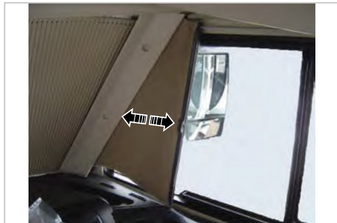
Fig.6.11 - Vikbara mörkläggningsgardiner för sidofönster
