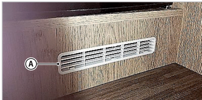
sl.6.1 - Stalni ventilacijski otvori
