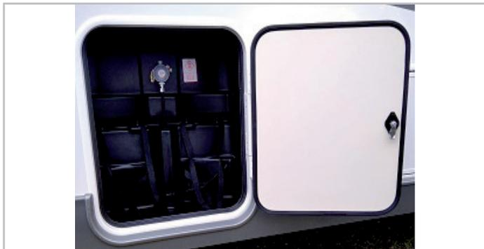
Fig.6.26 - Compartiment à bouteilles de gaz
