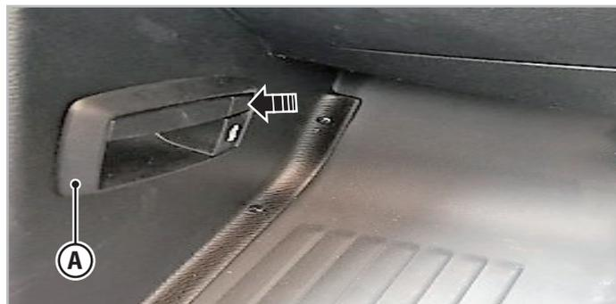
Fig.5.9 - Levier d'ouverture du capot - Type B
