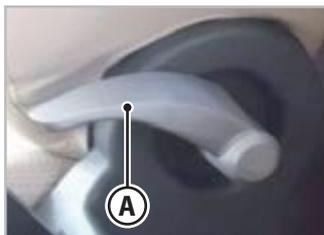
Fig.3.4 - Mando de regulación del respaldo
