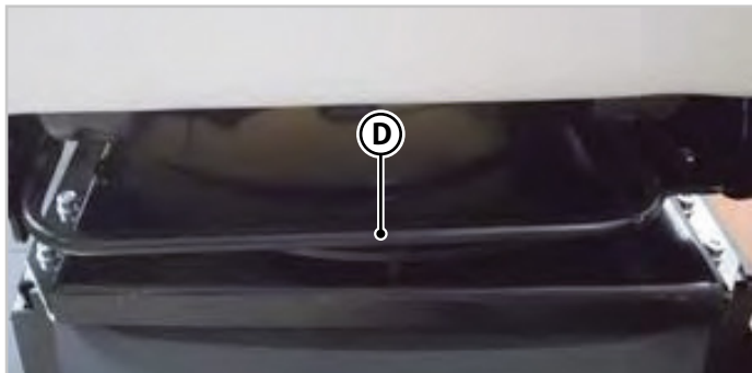
Afb.3.7 - Hendel voor het voor- en achterschuiven van de stoel
