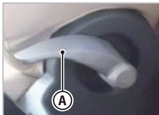
Фиг.3.4 - Ръкохватка за регулиране на облегалката
