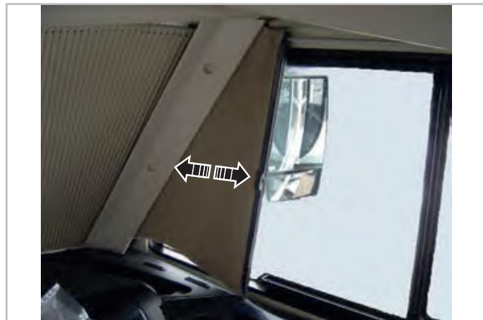
Фиг.6.11 - Сгъваеми затъмняващи щори за страничните прозорци
