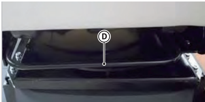
Фиг.3.7 - Лост за плъзгане на седалката
