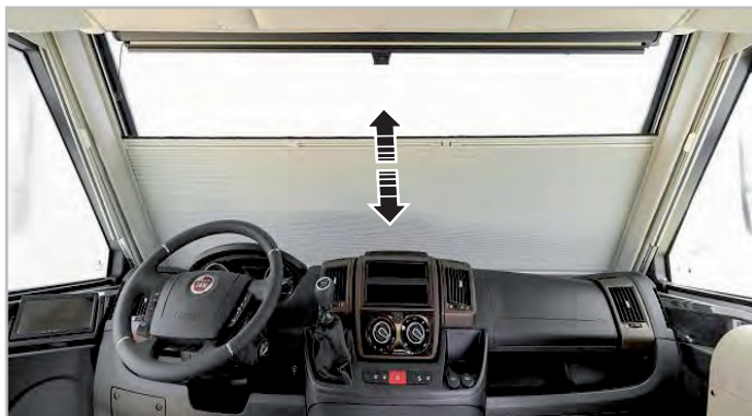
Фиг.6.12 - Сгъваема затъмняваща щора за предно стъкло
