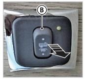
Fig. 6.36 - Heater switch
