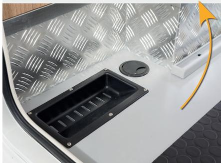
Predisposizione della parete con barre in alluminio per fissaggio attrezzatura personalizzata.
